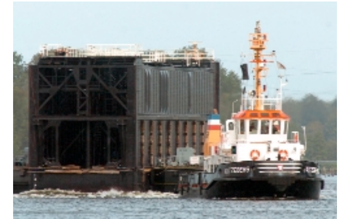
Schleppen eines Schleusentors durch den Nord-Ostsee-Kanal
