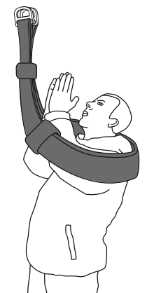
Einstieg bei geschlossener Rettungsschlinge
